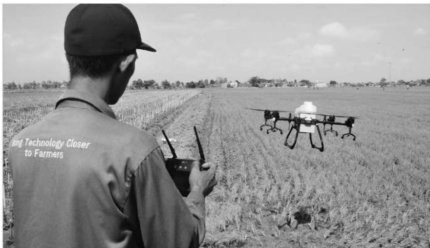
EFEKTIF DAN EFISIEN: Petugas mengoperasikan drone untuk menyemprotkan pestisida di lahan pertanian Desa Karangrowo, Kudus, Jawa Tengah, kemarin. Sebagian petani setempat memilih menggunakan penyemprotan pestisida dengan teknologi drone karena dinilai lebih efektif dan efisien bila dibandingkan dengan cara konvensional karena hanya memakan waktu rata-rata 15-20 menit di lahan satu hektare dengan tarif Rp250 ribu per hektarenya.
